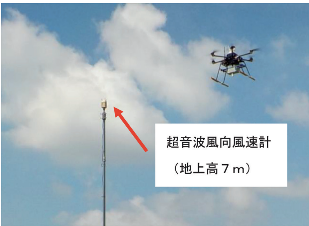
図4 超音波風向風速計との並行測定の様子
